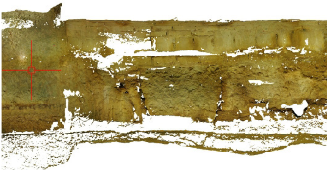
Figure 27 Erreur d'alignement lié à un chevauchement en dessous de 75%.
