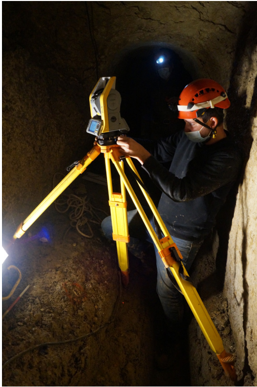
Figure 24 Mise en place du tachéomètre par un étudiant de la campagne 2021, section Torregrossa.
