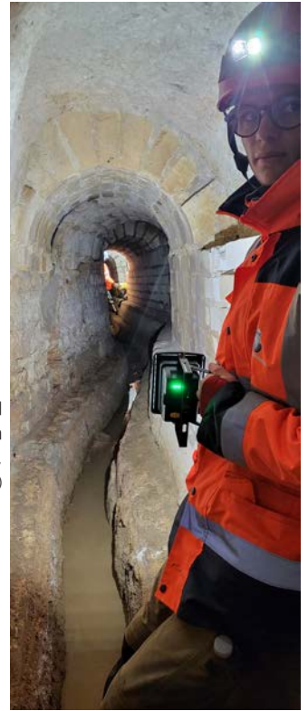
Figure 25 Mise en place du canevas polygonal par les étudiants de la campagne 2023, section Golf.
