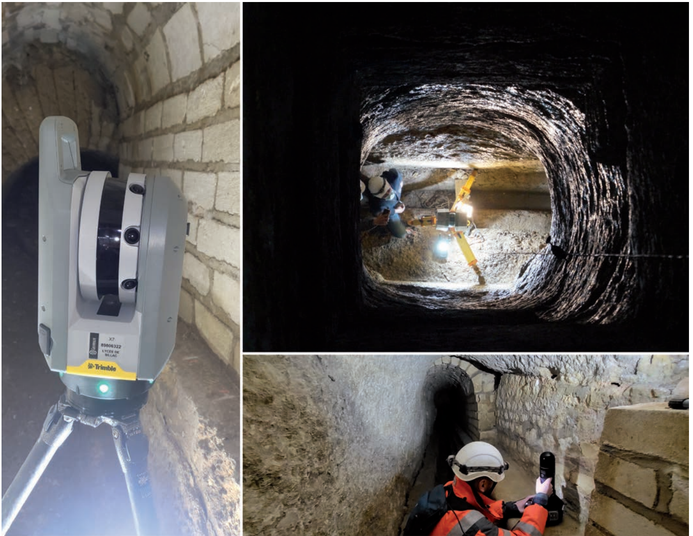
Figure 31 Scanners lasers utilisés lors des opérations lasergramétriques dans le tunnel, à gauche le Trimble X7, en haut à droite le Leica C10 et en bas à droite le Leica BLK2GO. © V. Miaillhe (SahCM)
