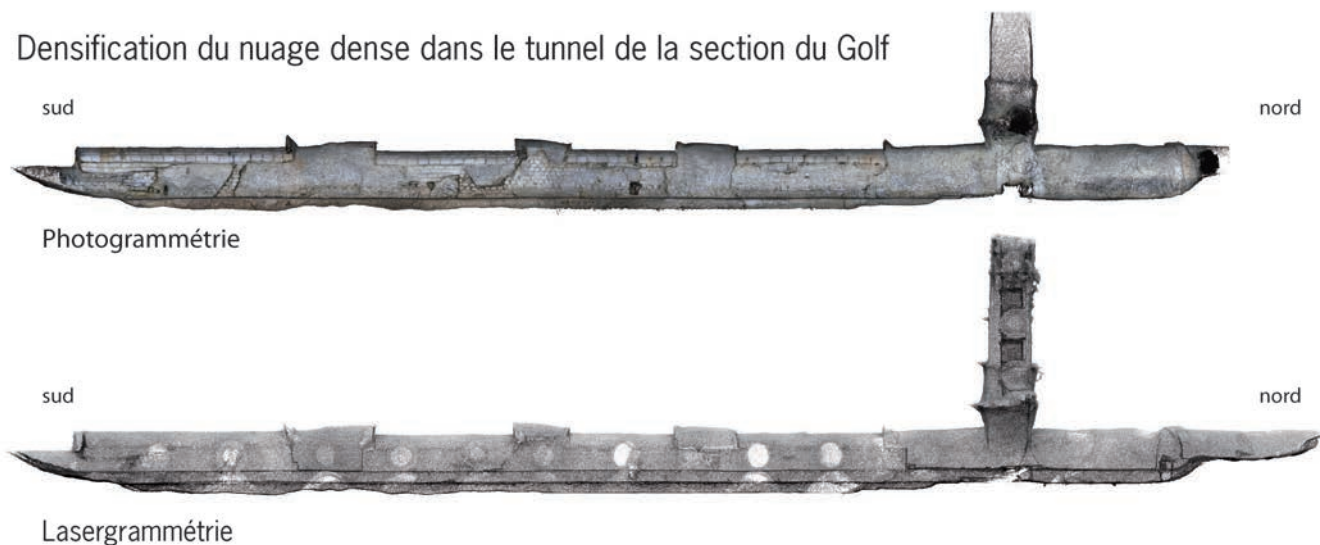
Figure 34 Comparaison des nuages denses, en haut la photogrammétrie et en bas la lasergrammétrie. © V. Mialhe (SahCM)
