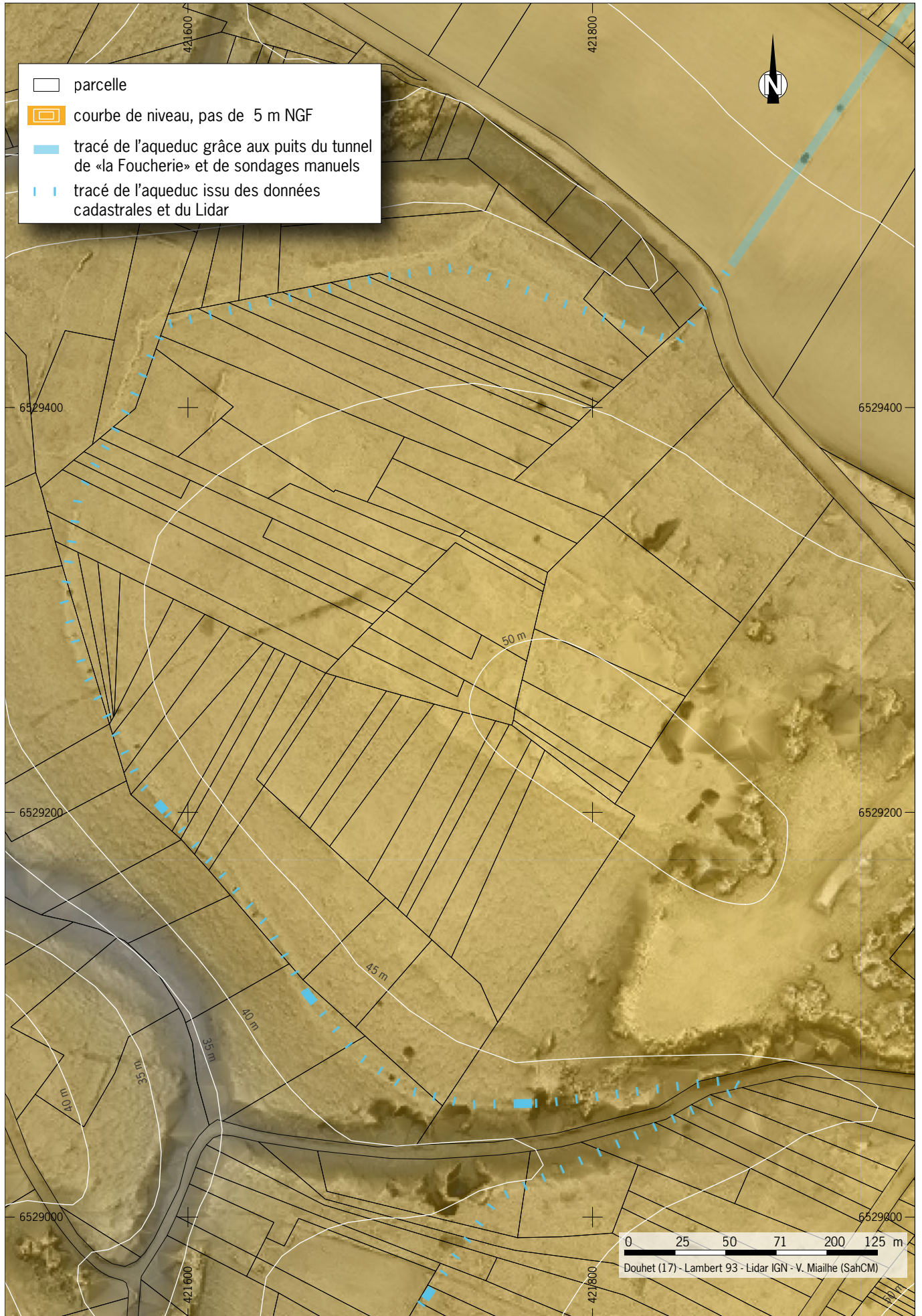
Figure 38 Interprétation du tracé de l'aqueduc en fonction des données cadastrales et du Lidar d'IGN. © V. Mialhe (SahCM)
