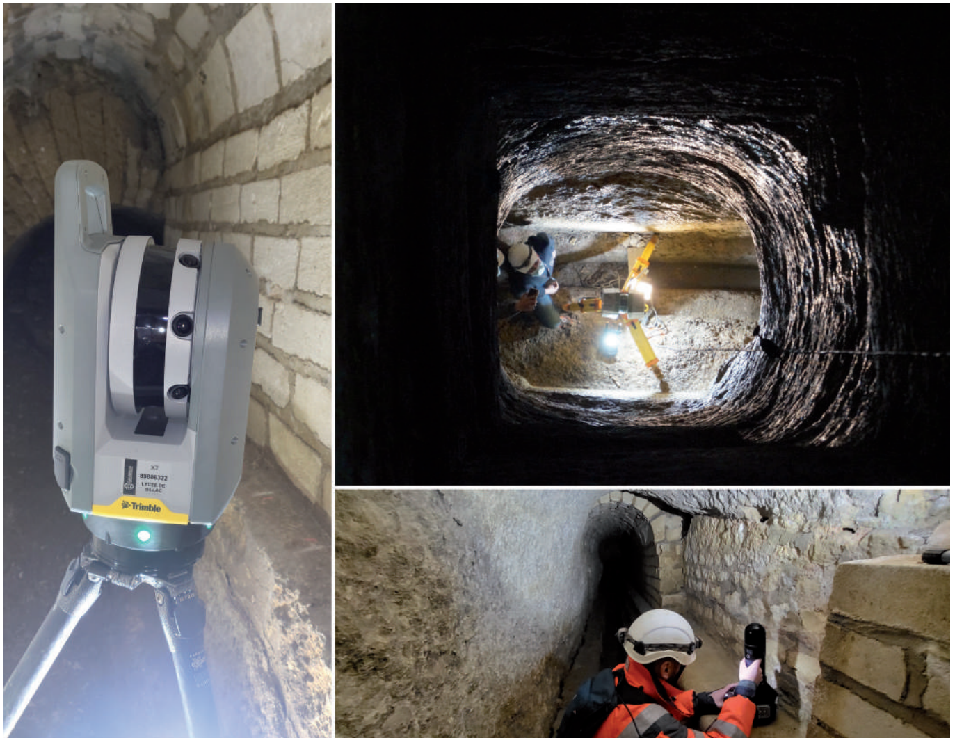
Figure 31 Scanners lasers utilisés lors des opérations lasergrammétriques dans le tunnel, à gauche le Trimble X7, en haut à droite le Leica C10 et en bas à droite le Leica BLK2GO. © V. Miaillhe (SahCM)
