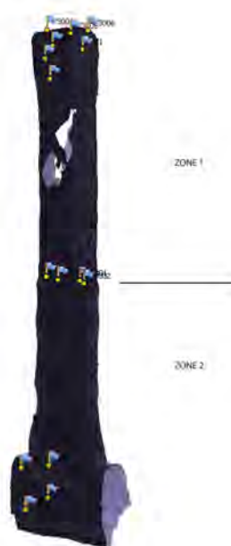
Figure 26 Méthodologie de la mise en place des points géodésiques à l'intérieur du tunnel et prise de vue photographique du conduit du puits.
