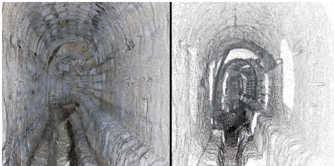
Figure 33 Comparaison des nuages denses à l'intérieur du tunnel, à gauche la photogrammétrie et à droite la lasergrammétrie. © V. Mialhe (SahCM)
